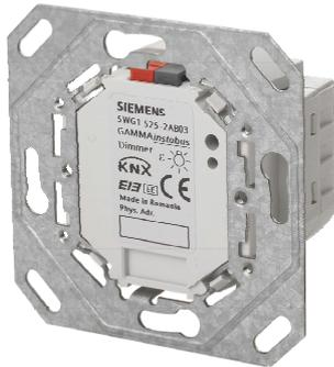
Der UP 525/03 Universaldimmer mit Hängebügel ist ein KNX Gerät mit einem Dimmerausgang und einem Bus Transceiver Interface (BTI). Es wird in einer UP-Dose (60 mm Ø, 60 mm tief) installiert. Der Busanschluss erfolgt über eine Busklemme, die Stromversorgung der Aktorelektronik über die Busspannung.
