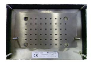
Adapterplatte zur Renovierung bestehender Briefkastenanlagen um ein Comelit Sprechgitter für die Lautsprechereinheit Art. 1621 und Art. 1621VC herzustellen. Zur Verwendung wird mittels mitgelieferter Schablone ein Ausschnitt an der Frontseite des Installationsfaches der Briefkastenanlage angezeichnet und ausgeschnitten. Die neue Sprechgitterfront wird montiert und die Schablone dient als Gegenstück zur Befestigung.
