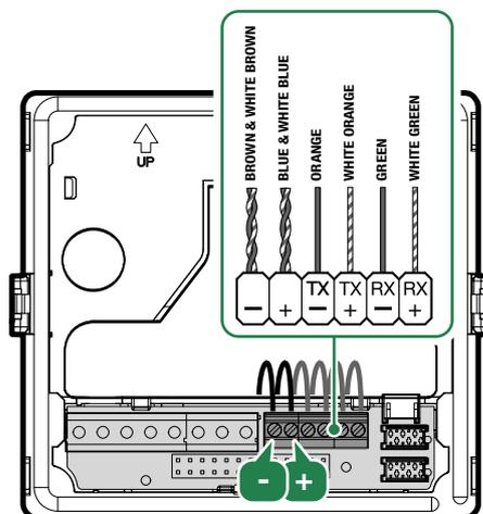
**B** Spannungsversorgung mit Zusatznetzteil Art 1595 oder Art. 1596B
