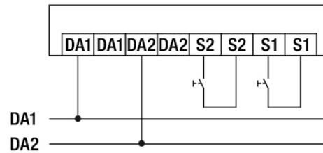
Standardbetrieb mit zusätzlichem Anschluss eines Tasters, Leitungslänge von Taster zu Präsenzmelder maximal 30 m.
