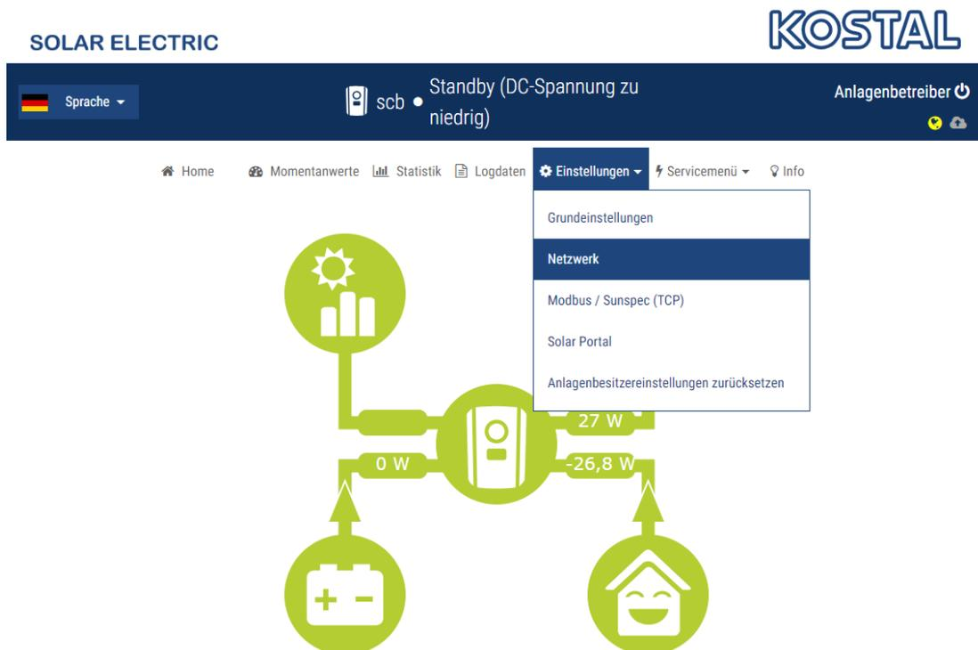
Im Menü „Netzwerk“ eine passende statische IP-Adresse für den Wechselrichter vergeben.
