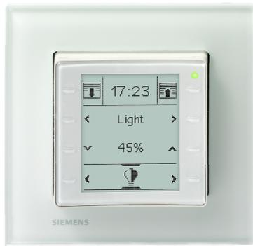
Das Raumbediengerät vereint die Funktionen eines Dot-Matrix LCD Anzeigedisplays mit bis zu 10 Raumbedienfunktionen, eines Einzelraumtemperaturreglers mit Sollwertvorgabe und Betriebsarteneinstellung, eines Temperatursensors und eines Fan-Coil Unit Bediengerätes in einem Busteilnehmer.
