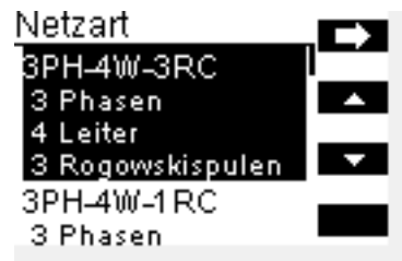
Bild 5-6 Auswahl Netzart mit Rogowski-Spulen
