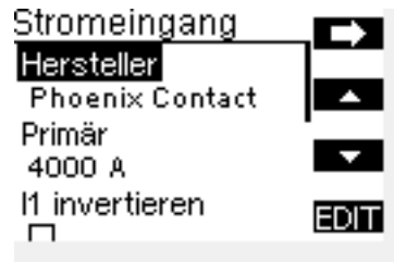
Bild 5-8 Stromeingang (Energiesmessgerät mit Rogowski-Spule)
