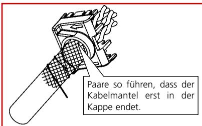
Aderpaare durch das Loch der Aderaufnahme führen und entsprechend dem gewünschten Farbcode ausrichten.
