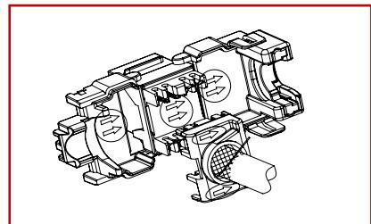
Stellen Sie sicher, dass die Pfeile auf der Aderaufnahme und dem Gehäuse in dieselbe Richtung zeigen.
