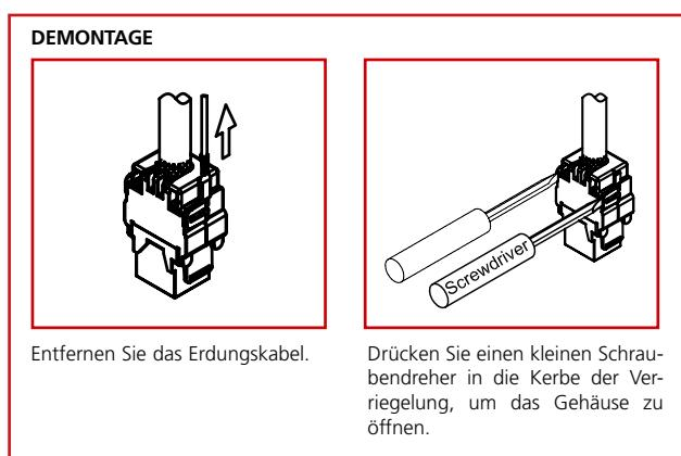
Entfernen Sie das Erdungskabel.
