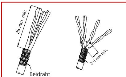
Entfernen Sie vom Kabelende mindestens 26 mm des Kabelmantels. Ziehen Sie den Gesamtschirm über den Kabelmantel und wickeln den Beidraht wie dargestellt um den Schirm. Paarschirmungen min. 3,5 mm überstehend, radial schneiden und entfernen.
