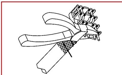
Schneiden Sie die überstehende Ader so nahe wie möglich an der Außenkante der Aderaufnahme ab. Watenfreien Seitenschneider verwenden.
