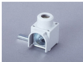
31 028 Anschlussklemme, seitlicher Anschluss für Kammschiene 31 014, 31 024, 31 309, 31 311 6 - 50 mm 2
