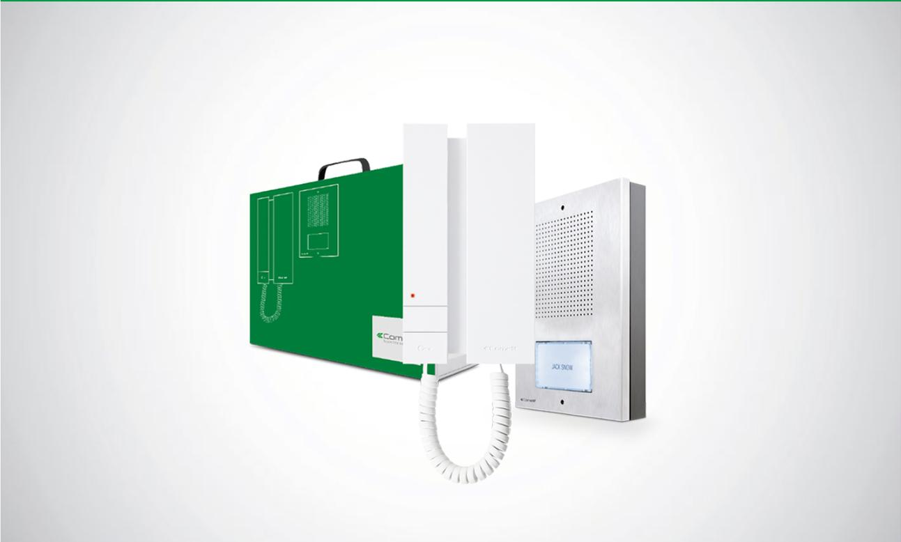
Einfamilienhauskit EXTRA KAE5061. Dieses Kit für traditionelle Systeme verwendet 5 Adern für die Verbindung von Außen- und Innenstation in der Ausführung Einfamilienhaus und besteht aus den Komponenten Außensprechstelle mit einer Taste KIT EXTRA 5-Draht Art. ET5001 mit einem Unterputzgehäuse für Kit Türstation EXTRA Art. ET9150 und einem Aufputzgehäuse für Kit Türstation EXTRA Art. ET9160, dem Netzgerät Art. 1200 und einer Innenstation Mini Audio mit Hörer Art. 2702W.
