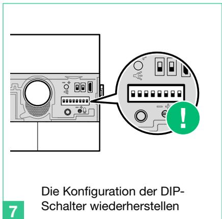
Die Konfiguration der DIP-Schalter wiederherstellen
