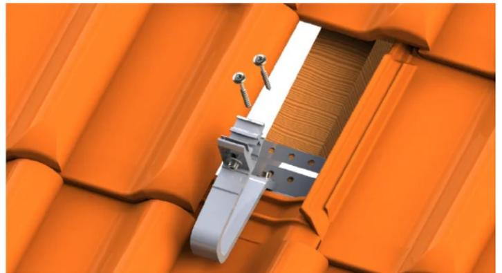
Der Dachhaken-Bügel darf nicht direkt auf dem darunterliegenden Ziegel aufliegen. Halten Sie eine Distanz von 3-5 mm ein.
