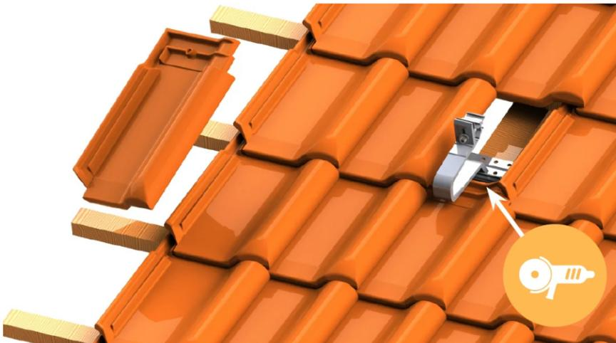
Optional kann der Ziegel, der unter dem Dachhaken liegt, durch einen Ziegelerersatzplatte ersetzt werden.
