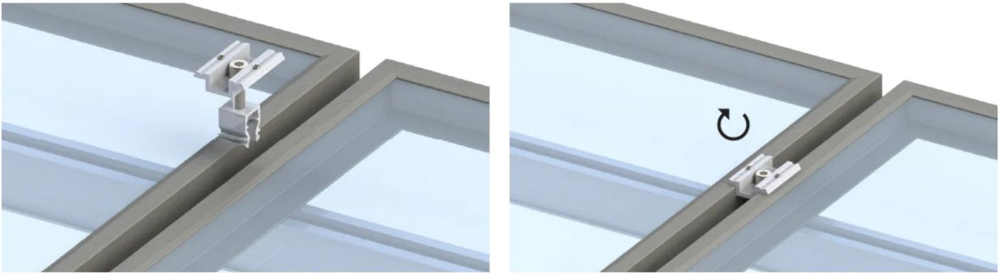
Das jeweils letzte Modul einer Modulreihe mit Abschlussklemmen, wie bereits beschrieben, montieren. Montage der verbleibenden Modulreihen analog.
