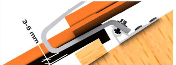
Entfernen Sie ggf. Teile der Lippe des darunterliegenden Dachziegels mit einem Winkelschleifer (Diamantblatt).
