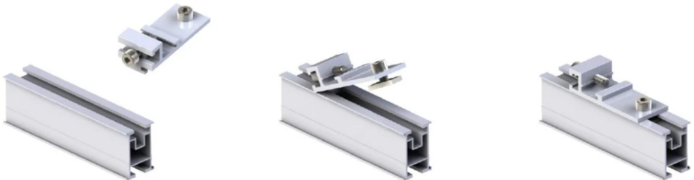
**Bitte beachten:** Werden die Trägerprofile „Basisschiene“ vertikal, parallel zum Ortgang montiert, muss die Trägerprofil-Fixierschraube des Kreuzverbinders immer nach oben Richtung First ausgerichtet sein.
