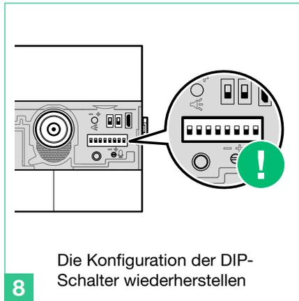
Die Konfiguration der DIP-Schalter wiederherstellen
