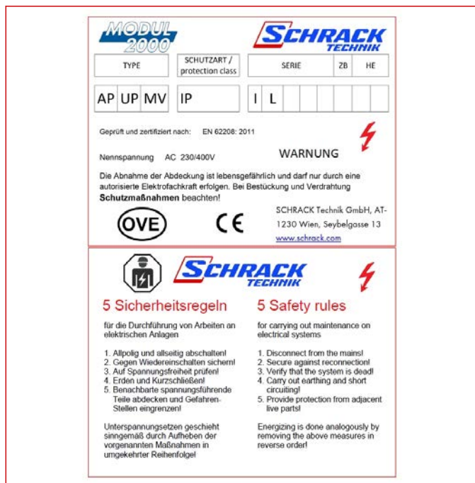
IL900375-C (Typenschild Modul 2000 inklusive 5 Sicherheitsregeln)
