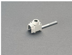
31 157 Anschlussklemme, frontaler Anschluss für Kammschiene 31 101 und 31 102 6 - 25 mm 2
