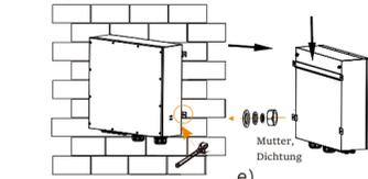
Hinweis: Bitte beachten Sie den Wenderadius der vorbereiteten Kabel über den Abstand zwischen dem Boden der Parallelbox und dem Boden.
