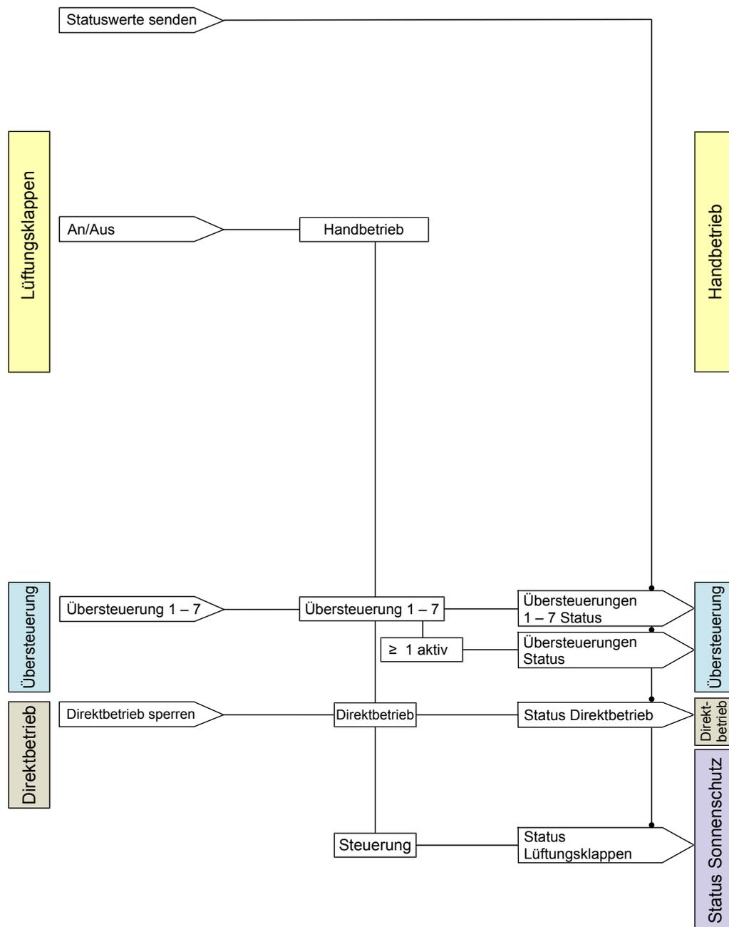
Abb. 11: Lüftungsklappen
