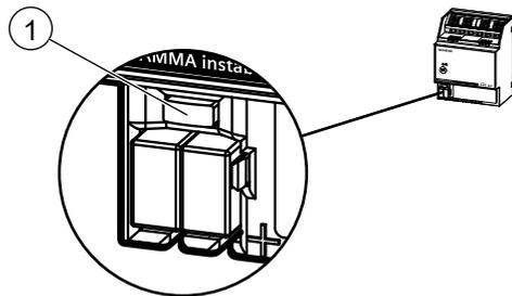
Abb. 4: Programmier-LED und Programmier-Taste (Abbildung beispielhaft)
