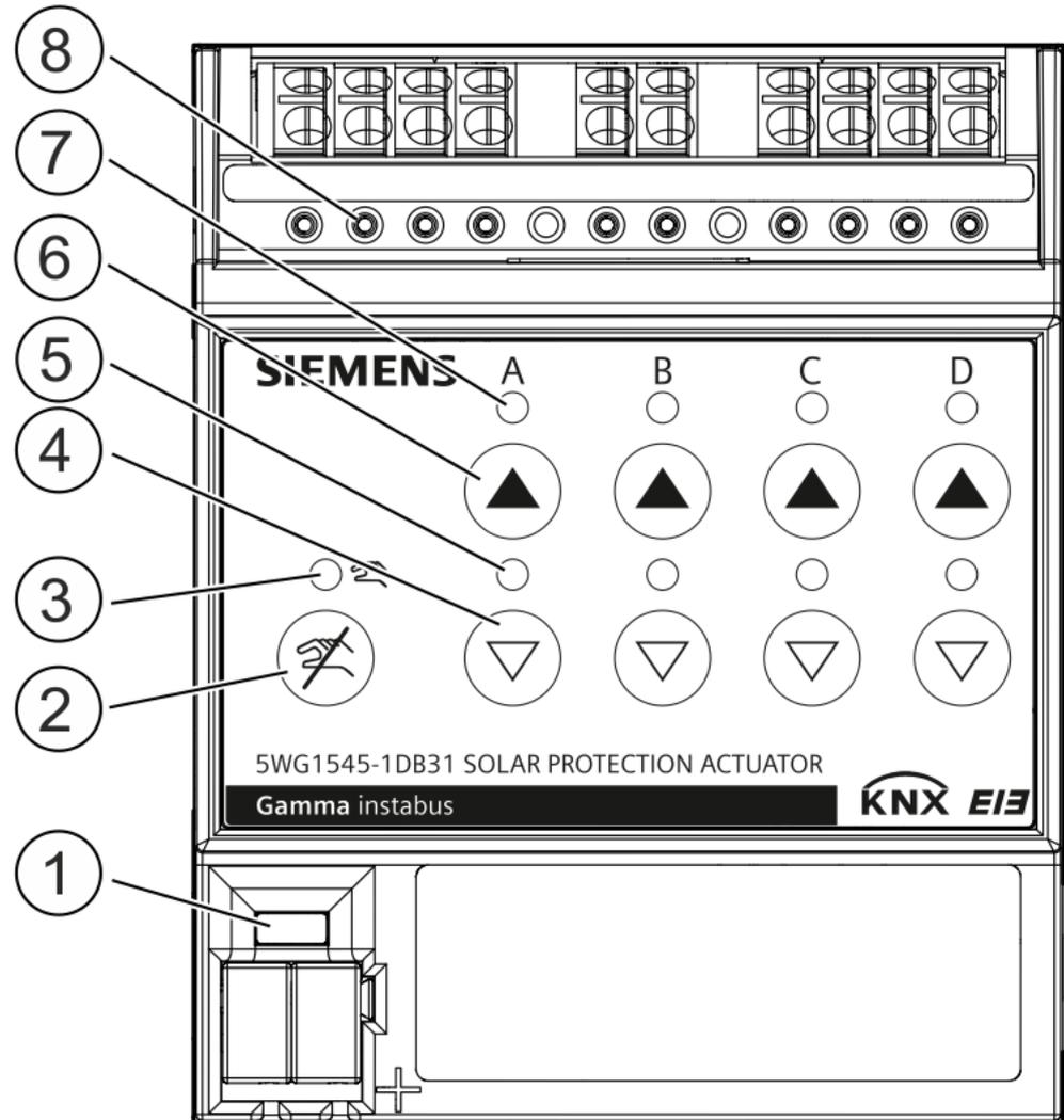
Abb. 1: Bedien- und Anzeigeelemente Sonnenschutzaktor N 545D31, 4 x 6 A DC
