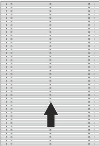
Der Sonnenschutz fährt von der unteren Endlage in die obere Endlage und misst die Fahrzeit. Diese speichert der Sonnenschutzaktor als „Fahrzeit von unten nach oben“ ab.
