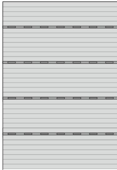
Von der tatsächlichen Fahrzeit wird die „Fahrzeit zwischen Aufsetzen Rollladen und komplett geschlossen“ abgezogen. Somit bleiben die Lüftungsschlitze offen.
