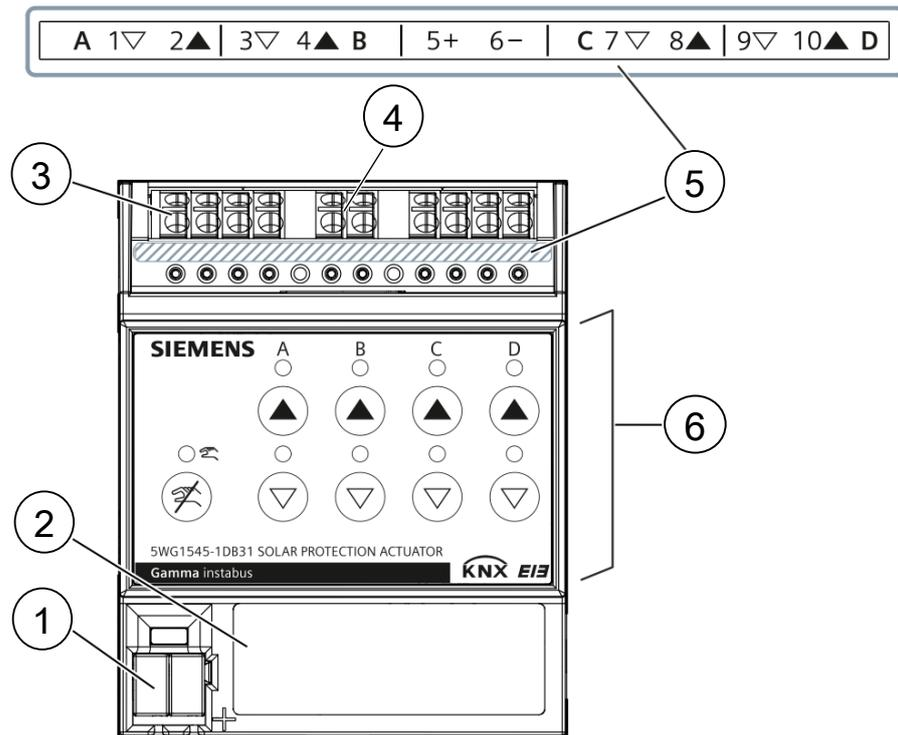
Abb. 2: Lage und Funktion der Anschlüsse und Beschriftung Sonnenschutzaktor N 545D31, 4 x 6 A DC
