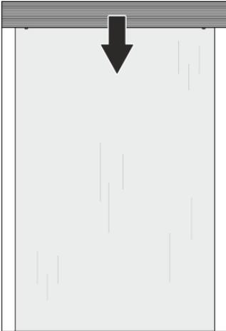
Nachdem der Sonnenschutz die obere Endlage erreicht hat, fährt er von der oberen Endlage in die untere Endlage und misst die Fahrzeit. Diese speichert der Sonnenschutzaktor als „Fahrzeit von oben nach unten“ ab.
