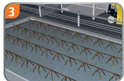
3 Betonfertigteil wird gegossen.
