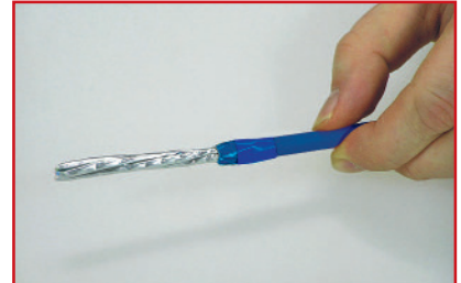
Das Geflecht mit Isolierband oder Kupferfolie fixieren. / Fix the braid by use of a glueing tape or copper foil.
