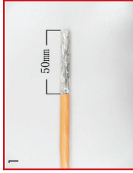
1 Kabelmantel entfernen / Strip outer cable sheath
