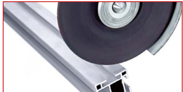
Schiene auf Länge schneiden
