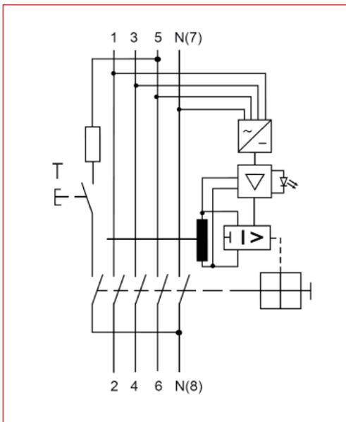
FI-Schutzschalter, Serie FID-B, Typ B, Bauart S
