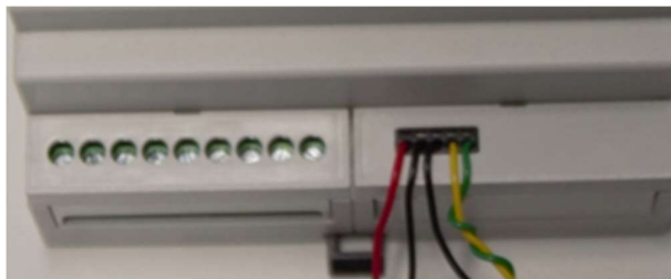
Abbildung 8: Beispielhafter Anschluss Modbus Interface URNA0345-C.COM
