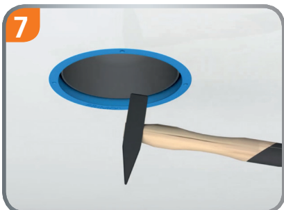
Lüftungshülse von unten mit Hammer einschlagen.
