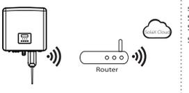
Schritt 2. Stecken Sie Pocket WiFi in den DONGLE-Anschluss. Please check the Pocket WiFi user manual/Pocket LAN user manual/4G user manual for more details.
