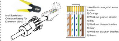
Schritt 5. Stecken Sie die Kommunikationsleitung (CAN/DRM/OFF) in den entsprechenden Port, verriegeln Sie die Abdeckplatte und ziehen Sie die Überwurfmutter fest. Schließlich können die entsprechenden COM-, METER-, CT- und BMS-Leitungen gefunden werden, um sie in die entsprechenden Anschlüsse des Wechselrichter-Kommunikationskabels einzufügen. Und schrauben Sie den Kommunikationsadapter fest.
