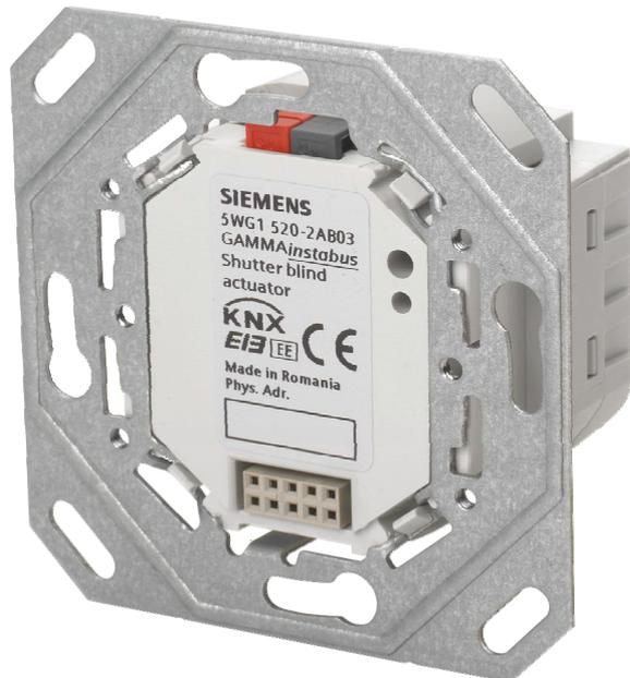
Der UP 520/03 Jalousieaktor mit Hängebügel ist ein KNX Gerät mit einem Relaisausgang und einem Bus Transceiver Interface (BTI). Es wird in einer UP-Dose (60 mm Ø, 60 mm tief) installiert. Der Busanschluss erfolgt über eine Busklemme, die Stromversorgung der Aktorelektronik über die Busspannung.
